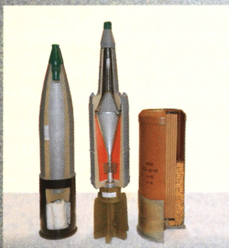
125-мм боеприпасы (слева направо): осколочно-фугасный снаряд 3ОФ26 выстрела 3ВФ36, кумулятивный снаряд 3БК18(М) выстрела 3ВБК-16, 125-мм металловый заряд Ж40, используемый для большинства 125-мм снарядов.
