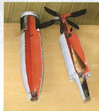
Разрезные 125-мм снаряды пушки 2А46: осколочно-фугасный (слева) и кумулятивный. На последнем хорошо видны лопасти стабилизатора.
