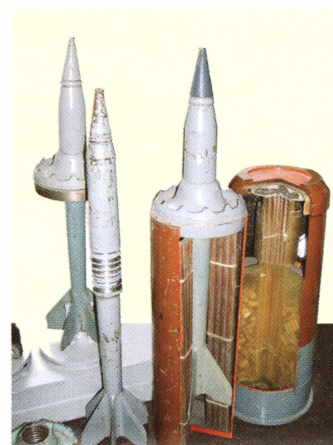
Элементы 125-мм бронебойно-подкалиберного выстрела 3ВВМ9 (слева направо): снаряд 3БМ22, корпус снаряда без поддона, снаряд с дополнительным металловым зарядом, стандартный металловый заряд.
