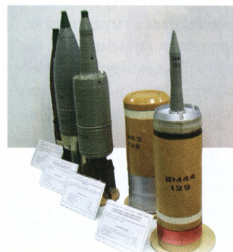
Вся номенклатура выстрелов к 125-мм танковой пушке: бронейно-подкалиберный, кумулятивный и осколочно-фугасный снаряды, стандартный метательный заряд.
